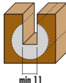
Cave per pannelli scorrevoli o per il passaggio di fili elettrici si eseguono dopo aver praticato nel legno una scanalatura per il passaggio del gambo della fresa.
